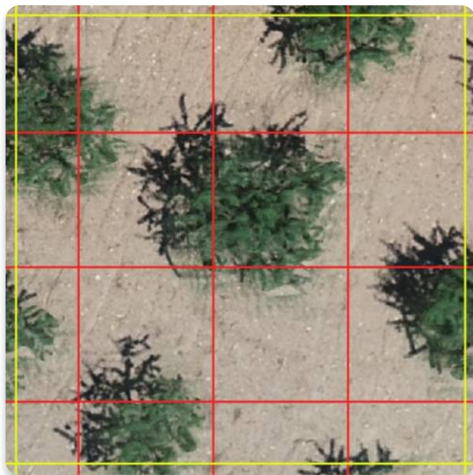
Um pixel Sentinel-2 (amarelo) cobre várias árvores; o PlanetScope (vermelho) aproxima-se da árvore.
