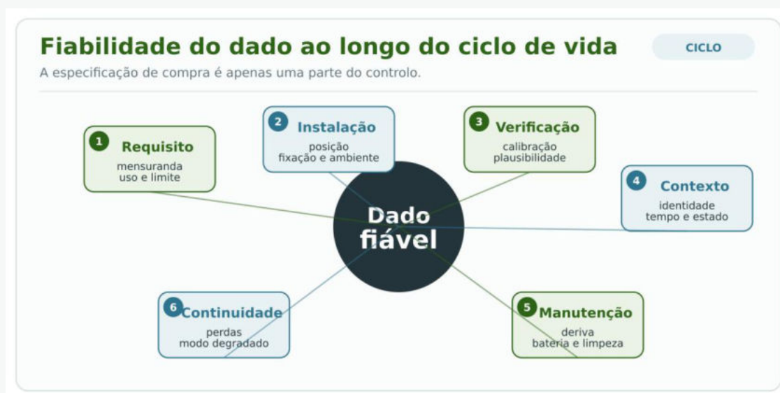
Figura 9 - Controlos que contribuem para a fiabilidade da medição e do dado ao longo do ciclo de vida.
