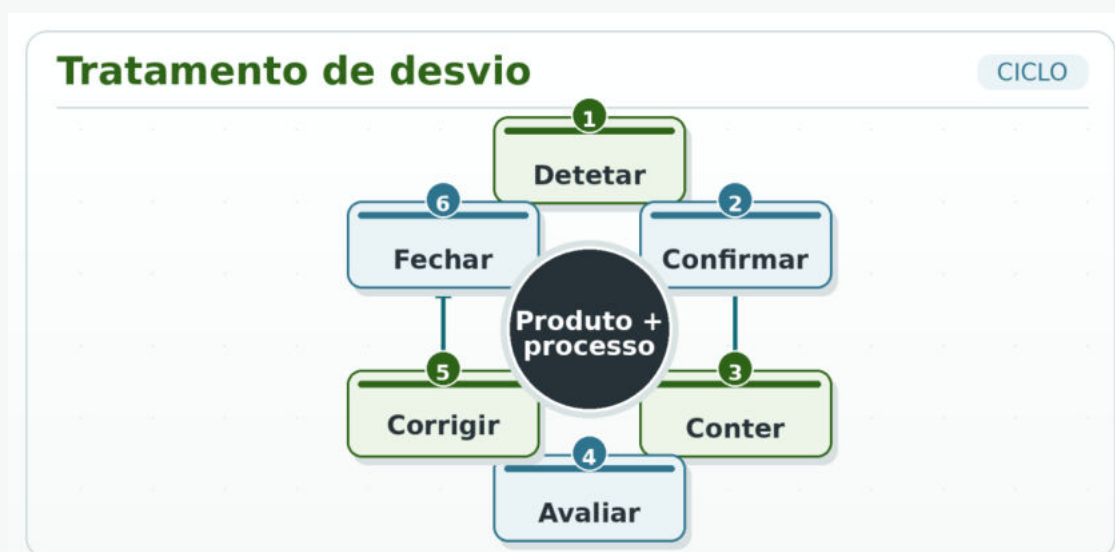
Figura 16 - Ciclo de tratamento de um desvio suportado por dados IoT.
