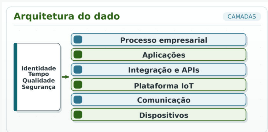
Figura 10 - Arquitetura em camadas do dispositivo ao processo empresarial.
