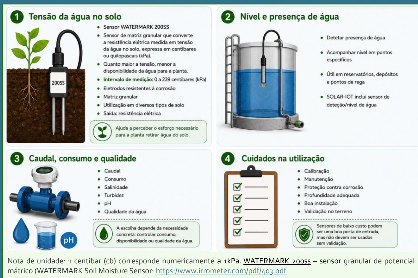
Figura 25 - Sensores para monitorização do solo e da água: aplicações e critérios de utilização
